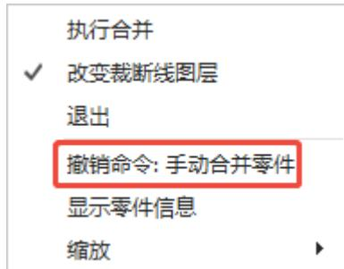
⑥重做手动合并零件：若不小心撤销了手动合并零件，想要返回到合并零件后的结果，可以在管材附近空白处点击鼠标右键，选择“重做命令：手动合并零件”，即会跳转到撤销手动合并零件前的状态。
