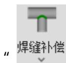
“**焊缝补偿**”下拉菜单的<补偿所有截面>会给当前界面上所有能加焊缝补偿的截面全部加上焊缝补偿，软件会根据截面信息自动计算出合适的刀路，这样加工出来的零件可以正常拼接。
