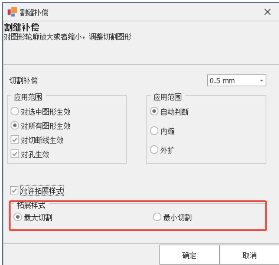
当管面上有斜切孔，要在这种斜切孔里插入与孔径相等的支管时，由于斜切孔的外壁轮廓线和内壁轮廓线并不一致，普通激光加工是按外壁轮廓线垂直于管面切割的，所以孔往往比支管小，支管在插入斜切孔时会产生干涉。
