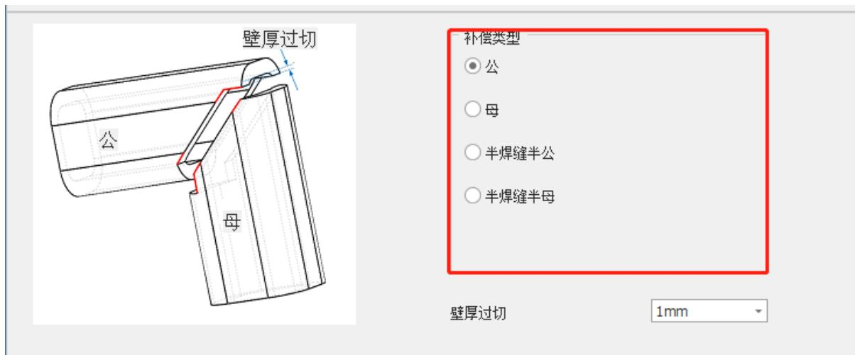
用户可以选择不同的补偿类型，对于倒角较大管壁较厚的斜切矩形管，由于内侧凸出造成干涉，导致斜切加焊缝补偿后还是拼不好，此时则可以选择设置<半焊缝半公母>拼接功能。
