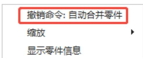
⑤重做自动合并零件：若不小心撤销了自动合并零件，想要返回到合并零件后的结果，可以在管材附近空白处点击鼠标右键，选择“重做命令：自动合并零件”，即会跳转到撤销自动合并零件前的状态。
